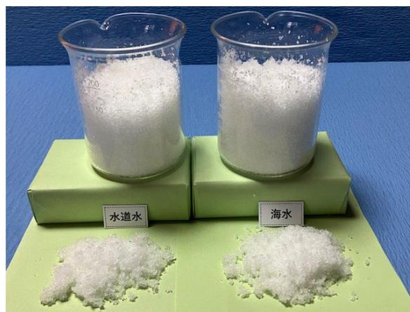
PAS添加、1分程度混練し、15分程度経過状態 完全に凝固している
