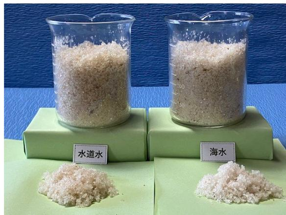
PAS添加、1分程度混練し、15分程度経過状態 完全に凝固している
